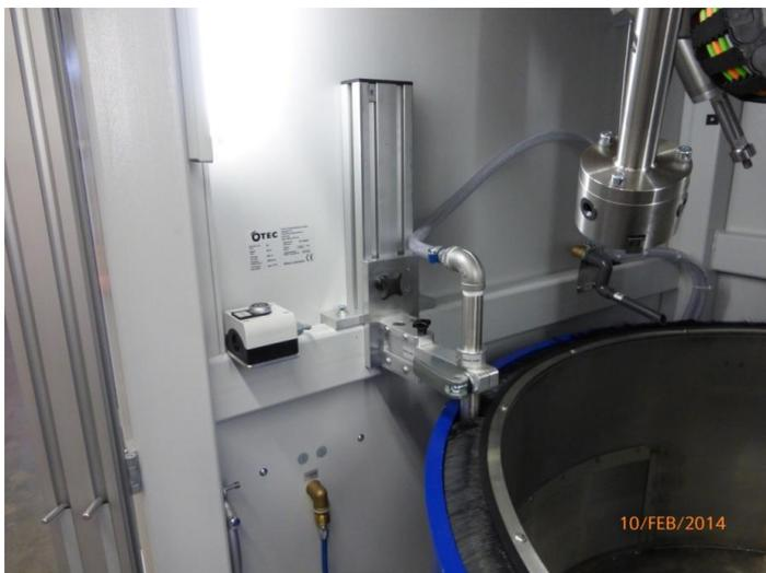
Figura 4: Lancia di aspirazione per eliminare l'acqua di scarico
