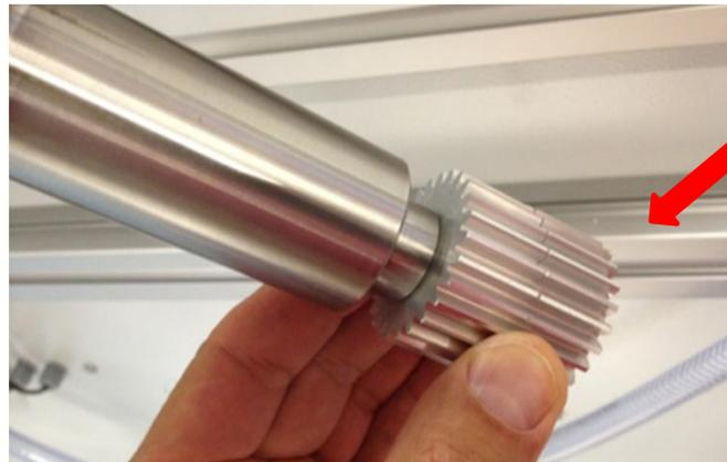
L'alloggiamento dell'utensile dispone di un sistema di serraggio ad aria compressa, per bloccare l'utensile nell'apposito foro.
