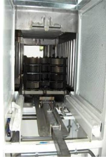
Per il carico è previsto un traslatore a carro con trave mobile, provvisto di nottolini a contrappeso e mosso da motoriduttore (con dispositivo a frizione) ingranaggio e cremagliera che muove le cariche tra la stazione di carico e la zona di sgrassaggio ad immersione. Potenza 0.75 Kw.
