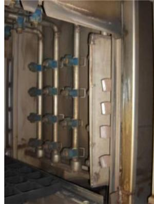
La soffiatura avviene mediante elettroventilatore posizionato nella zona di drenaggio dopo il risciacquo. Questa fase è prevista per favorire l'allontanamento del liquido di lavaggio dei pezzi, prima dell'ingresso nella fase di asciugatura.
