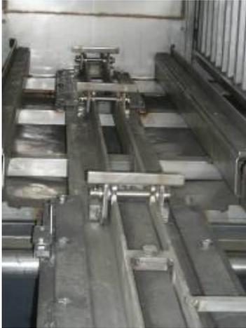
L'impianto di lavaggio sarà fornito di trasportatore a spinta con galoppini per spingere il piatto base delle ceste in trattamento nei vari stadi della macchina
